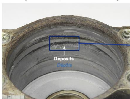
Fig. 45 Gros plan de la surface intérieure du boîtier de l'amortisseur. Close-up of inner surface of Damper Housing
