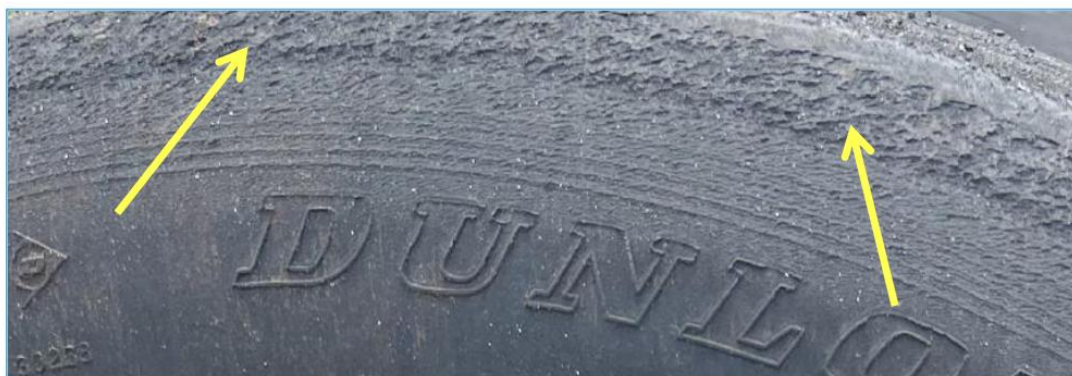
Fig. 16 Usure importante de l'épaule du pneu gauche Heavy wear to LH tyre shoulder
