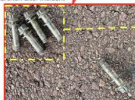
Boulons de roue retrouvés cassés après l'incident wheel bolts found broken after incident
