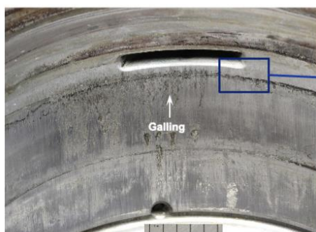
Fig. 47 Gros plan de la surface intérieure du boîtier de l'amortisseur. Close-up of inner surface of Damper Housing
