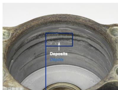
Fig. 45 (répétée) Gros plan de la surface intérieure du boîtier de l'amortisseur Close-up of inner surface of Damper Housing
