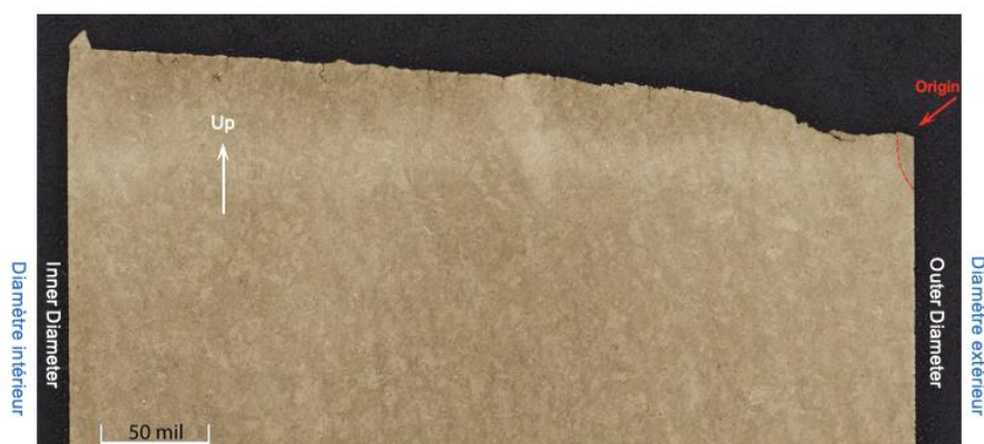
Fig. 74 Photomicrographies optiques de la section transversale attaquée chimique à travers la zone d'origine du cylindre intérieur, après retrait du placage. (La région légèrement plus foncée est délimitée en rouge) Optical photomicrographs of etched cross-section through origin area of Inner Cylinder after removal of plating. (Slightly darker region outlined in red).
