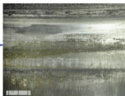
Fig. 46 Gros plan des dépôts le long de la surface intérieure. Close-up of deposits along inner surface
