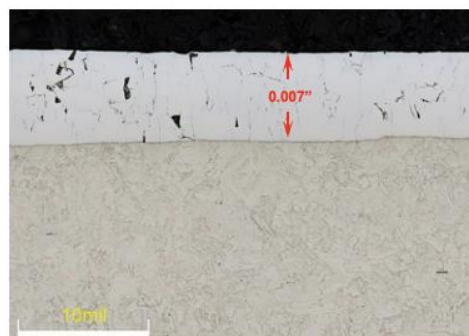
Fig. 63 Gros plan du placage au chrome Close-up of chromium plating
