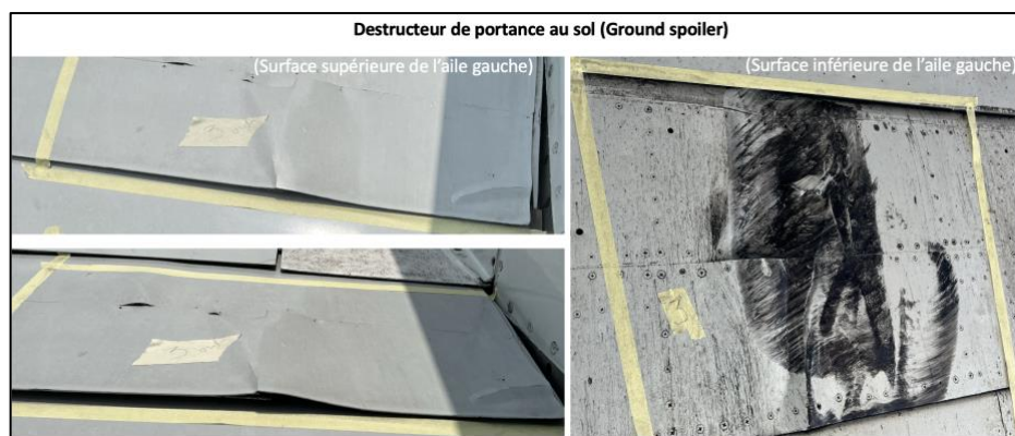
Fig. 9 Destructeur de portance au sol de l'aile gauche endommagé Damaged left wing ground spoiler
