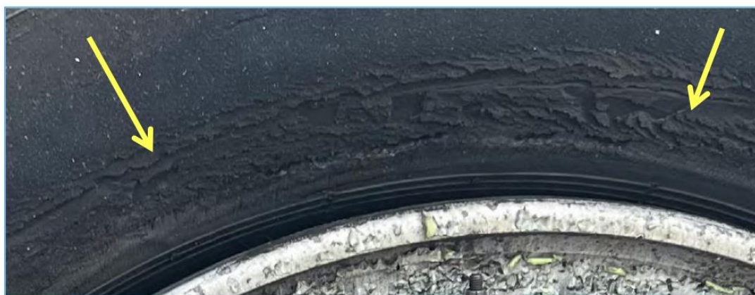
Fig. 17 Entailles sur la partie inférieure du flanc Lower sidewall gouges
