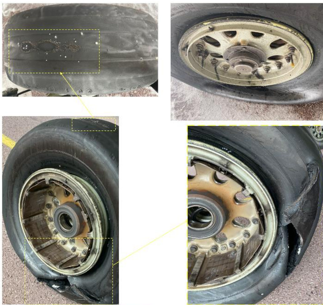
Fig. 82 Vue générale de la roue n°02 du train principal gauche General view of wheel No. 02 of the left main landing gear
