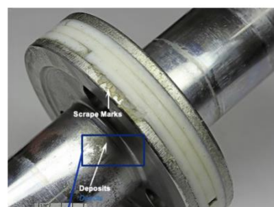
Fig. 50 (répétée) Gros plans du piston après extraction Close-ups of Piston after removal
