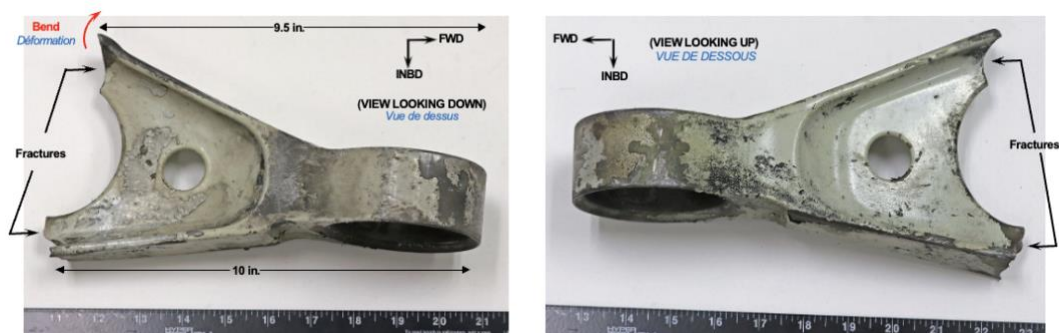
Fig. 20 Vues d'ensemble du demi-compas supérieur Overall images of the as-received fractured Upper Torsion Link
