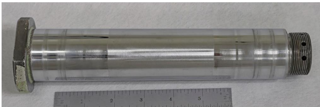
Fig. 41 Vue d'ensemble du boulon du demi-compas inférieur après nettoyage. Aucun dommage apparent Overall image of Lower Torsion Link Bolt after cleaning. No apparent damage.
