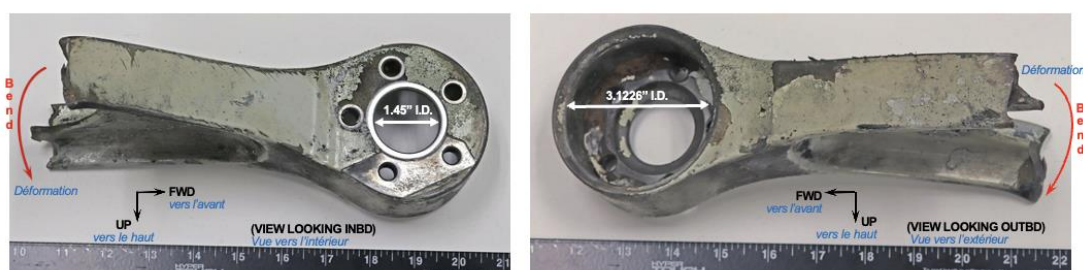
Fig. 21 Vues d'ensemble du demi-compas supérieur fracturé Overall images of the fractured Upper Torsion Link
