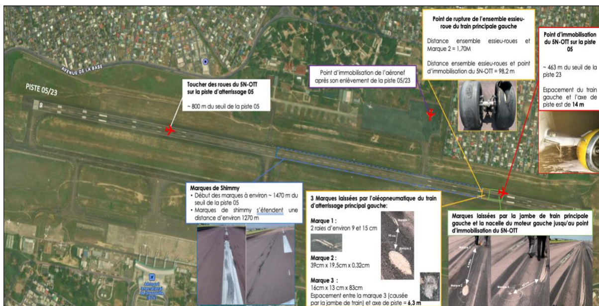
Fig. 3 Trajectoire du 5N-OTT et marques laissées sur la piste 05/23 (Source : GPS Tracks, annotation du BEA Congo)
