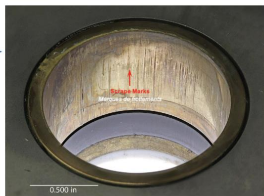
Fig. 54 Gros plan des marques de frottement dans la bague de palier Close-up of scrape marks in bushing
