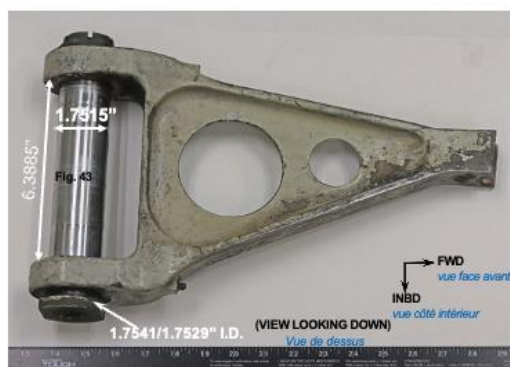
Fig. 33 et 34 Vues d'ensemble du demi-compas inférieur fracturé, avec le boulon Overall images of the fractured Lower Torsion Link with bolt.
