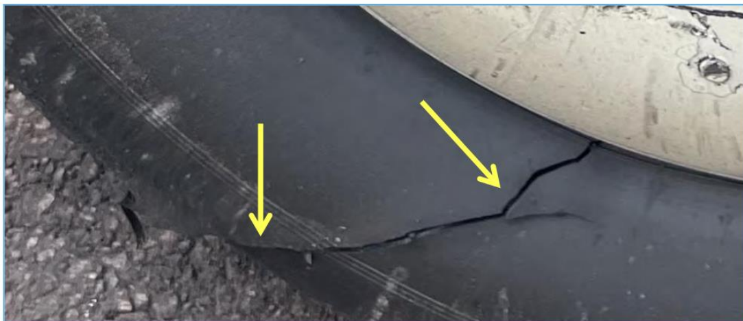
Fig. 14 Rupture du flanc du pneu gauche (LH) LH tyre sidewall rupture
