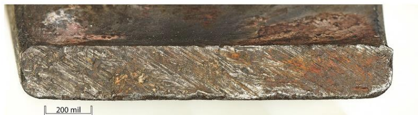
Fig. 35 Gros plan de la fracture inférieure traversant le demi-compas inférieur Close-up of lower fracture through lower Torsion Link.
