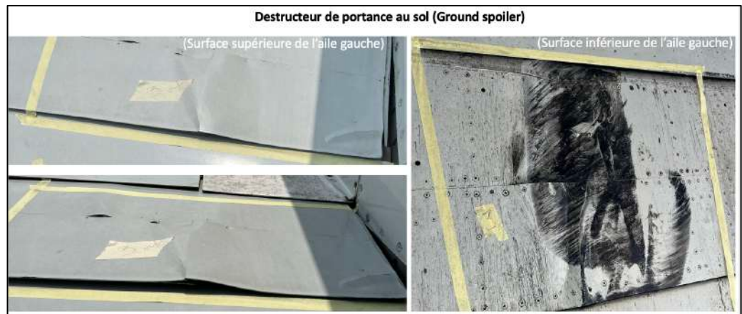
Fig. 9 Destructeur de portance au sol de l'aile gauche endommagé
