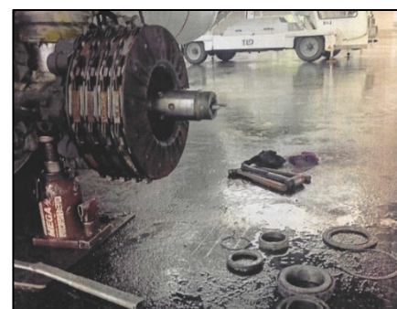
Fig. 1 Bloc de frein gauche et autres composants de l'ensemble roue à l'atterrissage (aéroport FCPP)
