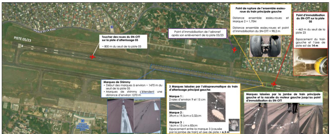
Fig. 1 Trajectoire du 5N-OTT et marques laissées sur la piste 05/23 (Source : GPS Tracks, annotation du BEA Congo) (Cf. Compte rendu préliminaire n°CRP 01/Mars 2023)
