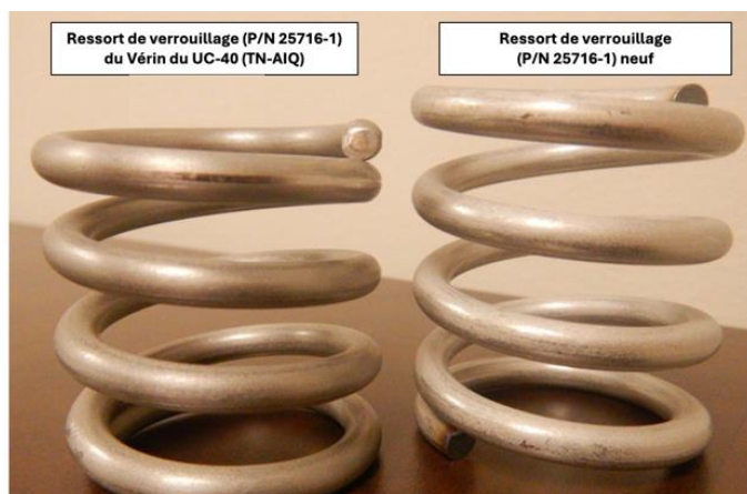
Figure 18 Ressort du vérin (installé sur l'UC-40) vs Ressort neuf
