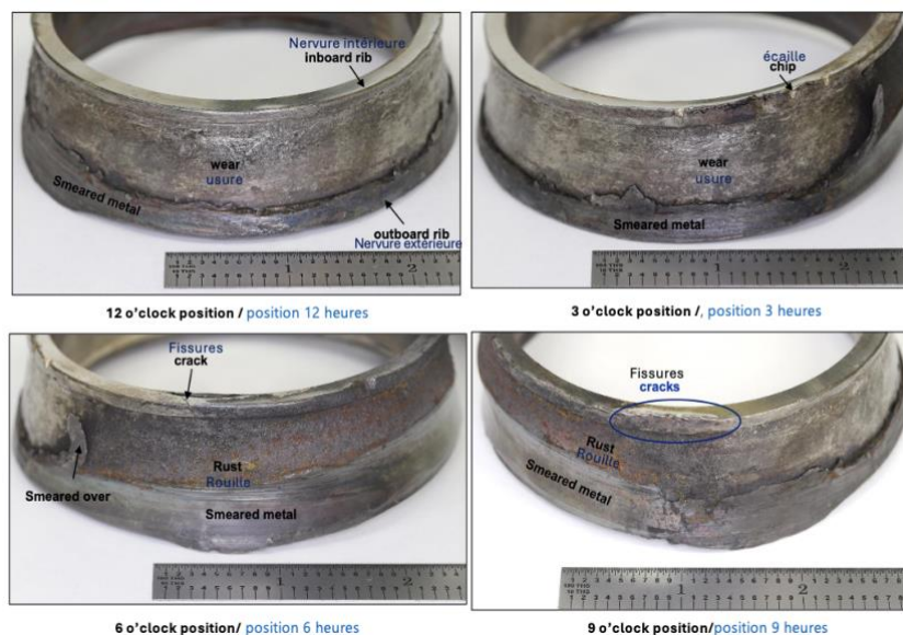
Fig. 13 Cône du roulement extérieur (Diamètre extérieur)
