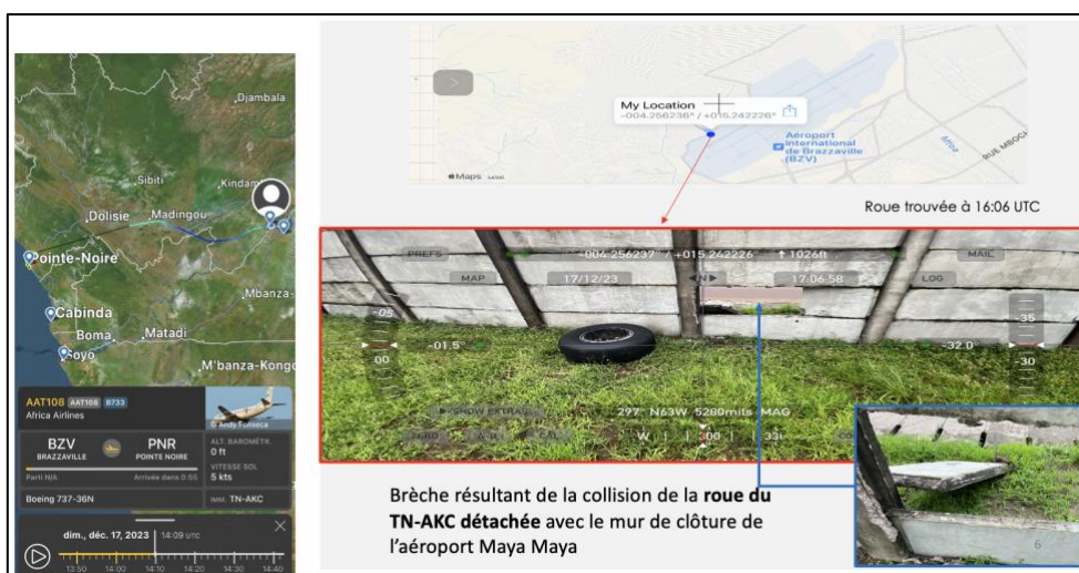
Fig. 2 Localisation de la roue n°02 du train d'atterrissage principal gauche détachée au décollage
